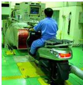
図 1. 二輪自動車の排出ガス試験
